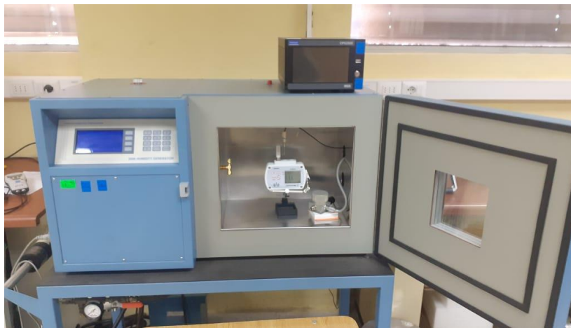
Figura 3. Montaje para la calibración del patrón viajero.
