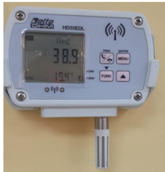
Figura 2. Patrón viajero usado en la comparación H-22 para participantes con cámara climática
